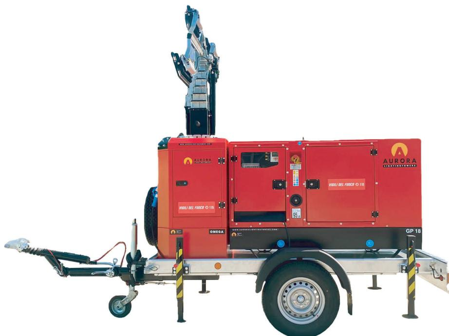
*ALLEGATOR GL nasce dalla volontà di unire gli strumenti fondamentali per intervenire rapidamente durante i disastri naturali. Un gruppo elettrogeno ed una torre faro in un'unica macchina dotata di carrello stradale ad alta velocità. La gamma prevede modelli standard da 10 a 20 kVA e torri faro con luci LED. Il gruppo elettrogeno oltre ad alimentare la torre faro è dotato di una presa ausiliaria per il collegamento di utensili esterni.*
