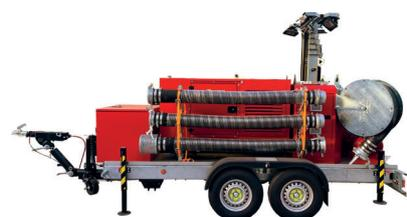
*ALLIGATOR GLP nasce dalla volontà di unire gli strumenti fondamentali per intervenire rapidamente durante i disastri naturali. Idrofoglia ha unito un gruppo elettrogeno, una elettropompa autoadescante ed una torre faro in un'unica macchina dotata di carrello stradale ad alta velocità. La gamma prevede modelli standard da 10 a 40 kVA, con elettropompe autoadescanti da 90 fino a 350 m<sup>3</sup>/h e torri faro con luci LED.*
